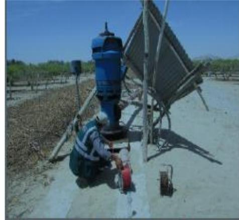
Vista del pozo con código IRHS-11-01-08-1352, el cual se encuentra con el equipo de bombeo en estado utilizado, la misma que el personal técnico del ALA RIO SECO, viene anotando las características del pozo, como así mismo viene realizando el nivel dinámico del agua
