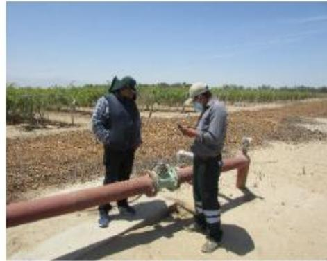
Vista del pozo con código IRHS-11-01-08-1352, y la tubería de descarga el cual se encuentra el Caudalímetro y el personal técnico el cual viene aforando el caudal obteniendo como resultado 31.0 l/s.
